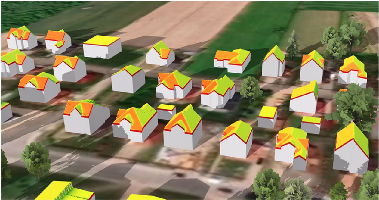
Rys. 19. Wizualizacja 3D obliczeń potencjału fotowoltaicznego powierzchni dachów.
