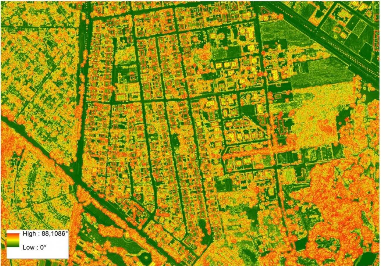
Rys. 4. Mapa spadków terenu i połączi dachów
