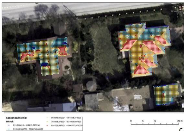
Rys. 7. Poszczególne etapy wyznaczania optymalnej lokalizacji ogniw fotowoltaicznych na dachach budynków: a) wartość nasłonecznienia dachu, b) wartość nasłonecznienia dachu przedstawiona za pomocą metody punktowej, c) średnie nasłonecznienie z podziałem na poszczególne połącze dachu, d) optymalna lokalizacja ogniw fotowoltaicznych z uwzględnieniem wartości nasłonecznienia, spadków i ekspozycji określonych jako preferowane
