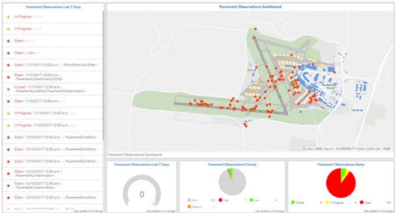
Rys. 4. Dashboards for ArcGIS pokazuje (w kolorze czerwonym) gdzie obecnie występują problemy z nawierzchnią pasa startowego.
