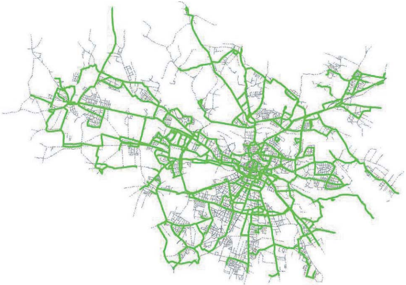
Rys. 3. Wyznaczony szkielet sieci wodociągowej dla Wrocławia.
