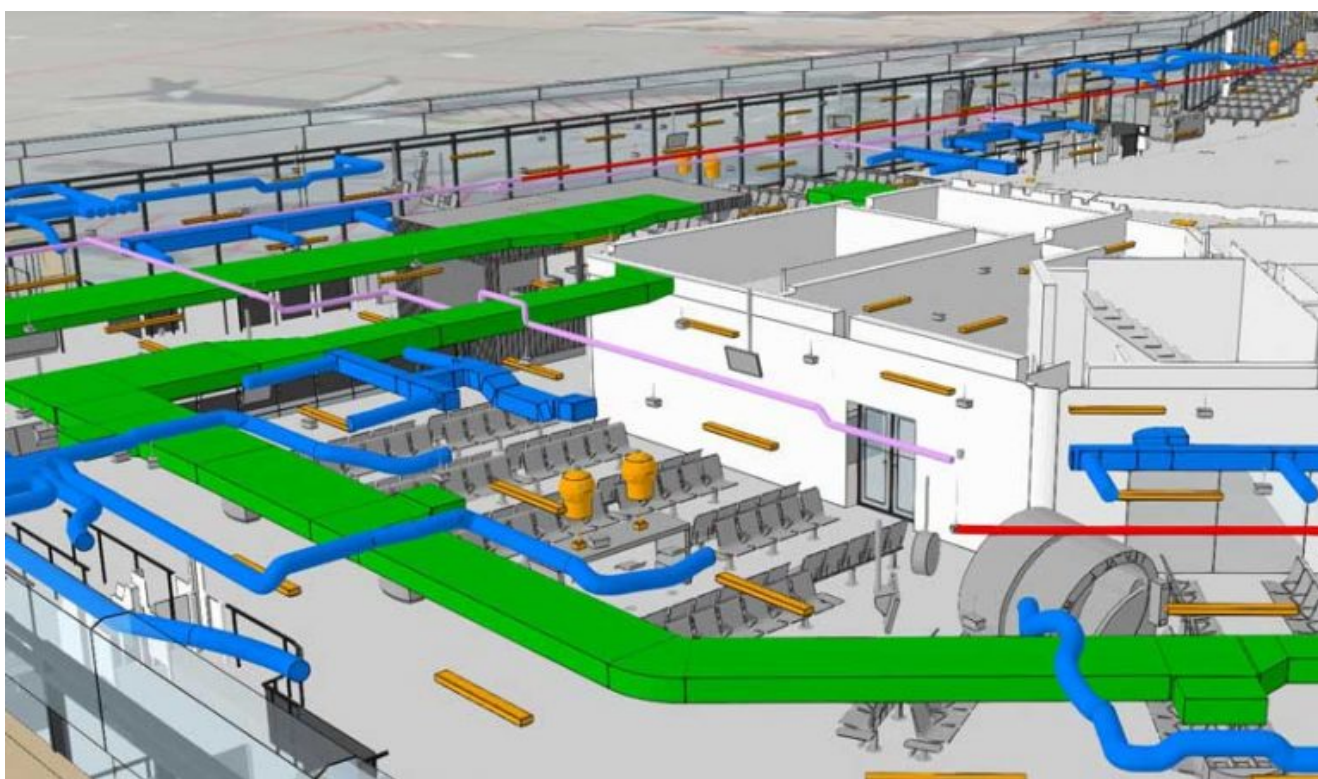
Rys. 1. Wycinek modelu BIM, przedstawiony w scenie internetowej ArcGIS, pokazuje systemy ogrzewania, wentylacji i klimatyzacji.
